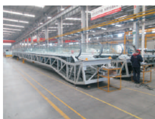
Производительность оборудования: используется для сварки эскалаторов.
